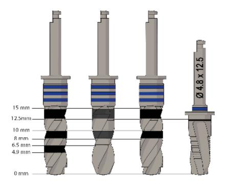
**Achtung:** die Laser-Markierungen auf den ICX-Bohrern dienen jedoch nicht zur exakten Bestimmung der Bohrtiefe! Um die exakte Tiefe des Implantatbetts zu bestimmen, sollte eine Tiefenmesslehre mit legalen, metrischen SI-Einheiten verwendet werden.
